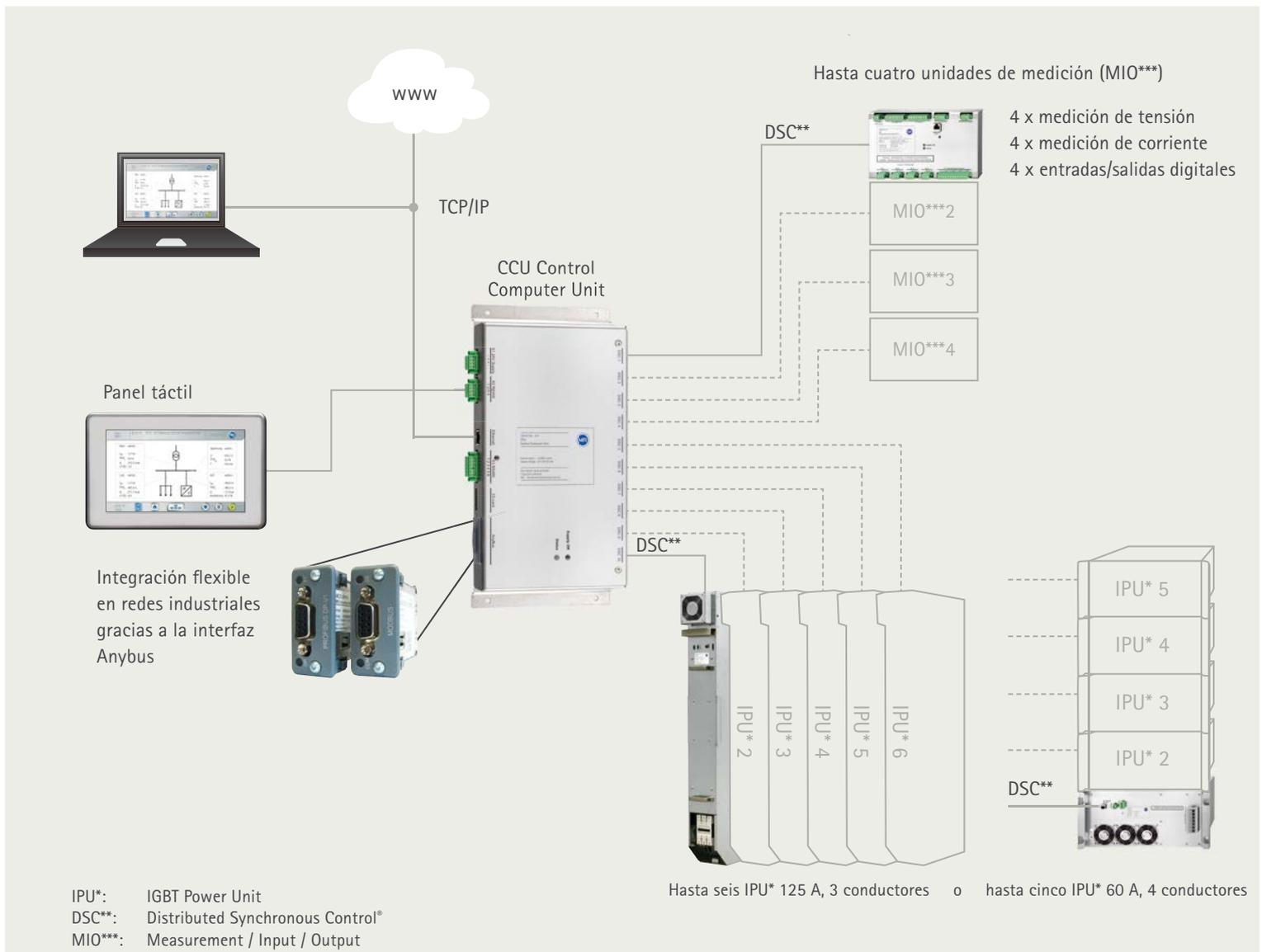
La arquitectura en red del GRIDCON® ACF ofrece una gran flexibilidad: una interfaz Anybus en el controlador facilita la integración en redes industriales. Además, todas las conexiones internas ofrecen un montaje sencillo y seguro contra fallos así como una transferencia especialmente fiable, incluso bajo la influencia de interferencias CEM. La interconexión en redes interna permite una elevada flexibilidad espacial. GRIDCON® ACF y MIO pueden instalarse, por ejemplo, en distintos recintos.
