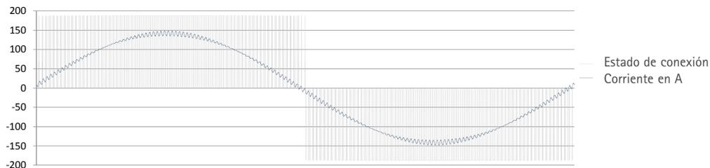
Estado de conmutación y ondulación (ripple) de la corriente – arquitectura de 3 niveles
