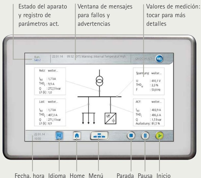
Además, el GRIDCON® ACF también puede manejarse basado en la web. Tras la integración en una red empresarial o a través de una conexión de radiotelefonía móvil, puede leerse y parametrizarse remotamente mediante un navegador.
