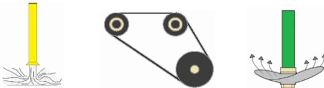
**Figura II.1- Ejemplo de algunos equipos en los que pueden generarse y acumularse cargas eléctricas estáticas.**
